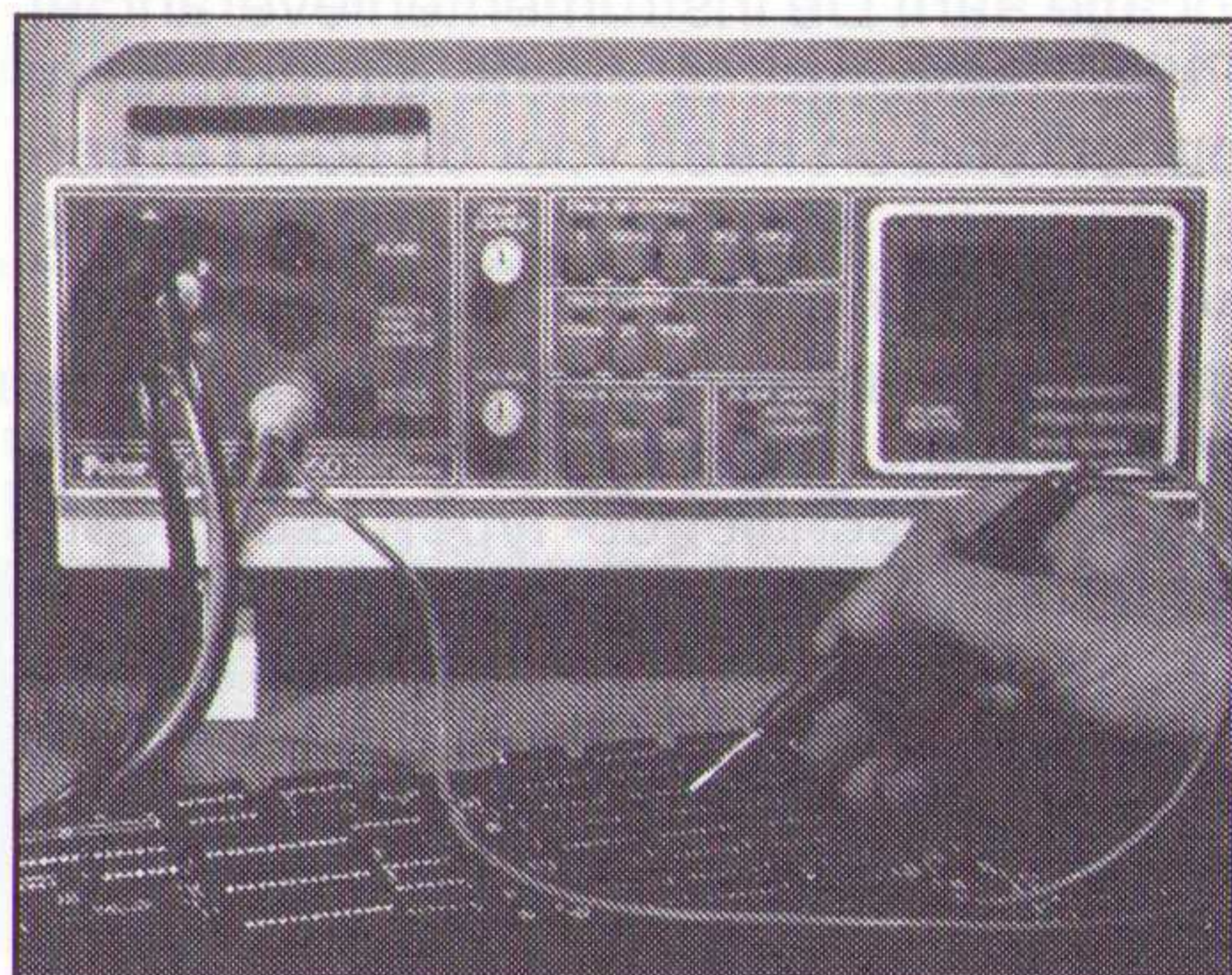
Fig. 5 Een situatie waarbij een sluiting tussen een spoor en een plane aanwezig is.
